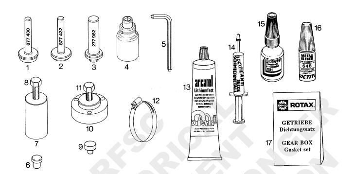
WERKZEUGE UND DICHTUNGSSATZ FUER GETRIEBEAUSFUEHRUNG "C" UND "E" REPAIR TOOLS AND GASKET SET FOR THE REDUCTION - GEARBOX "C" AND "E"
