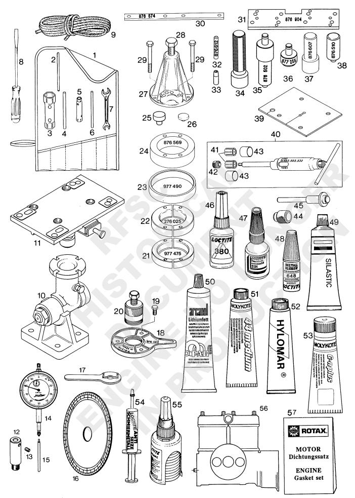
WERKZEUGE UND DICHTUNGSSATZ\_FUER DEN MOTOR REPAIR TOOLS AND GASKET SET FOR THE ENGINE
