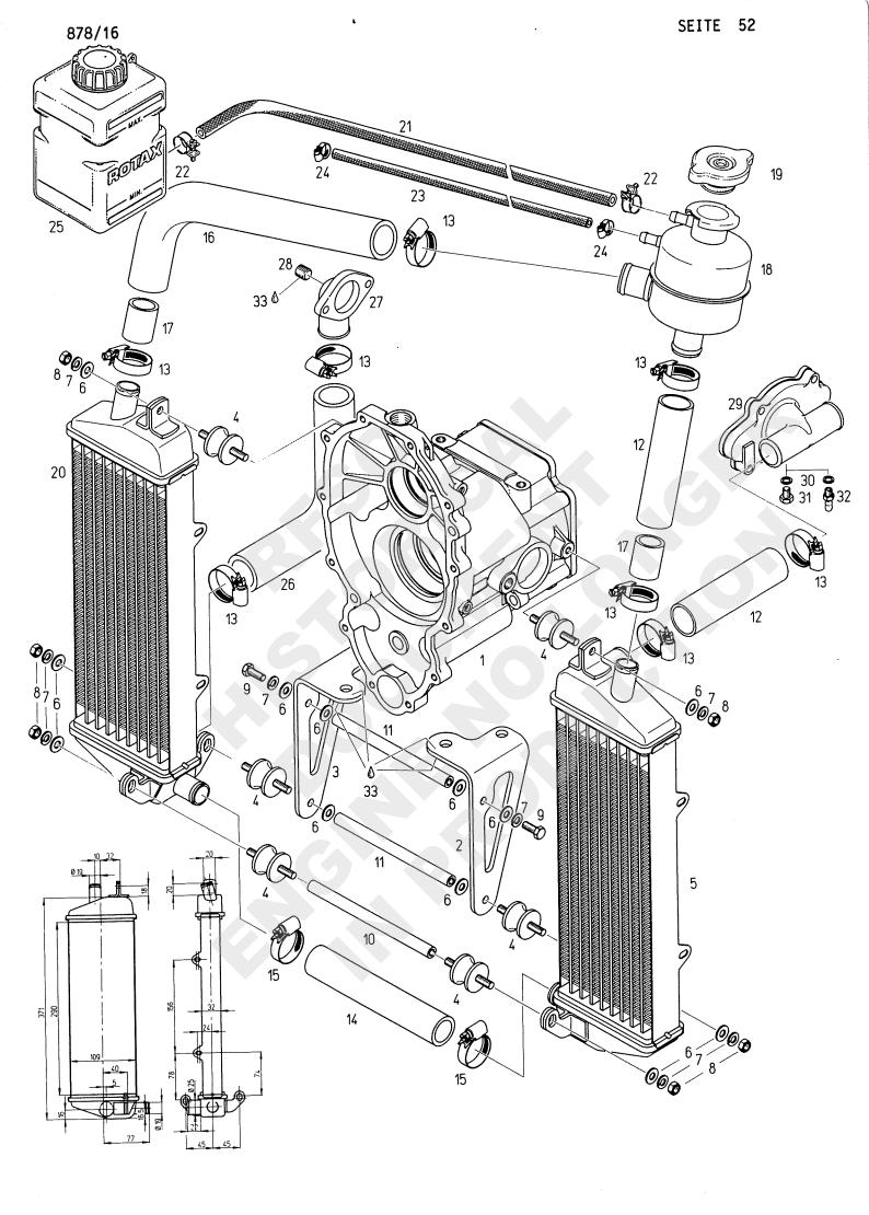
2-TEILIGES KUEHLERSET (KUEHLFLAECHE 2X3,2 DM2) HAENGENDE MOTOREINBAULAGE (ZUENDKERZEN NACH UNTEN) 2-PIECE RADIATOR SET (COOLING SURFACE 2X49,6 IN2) INVERTED INSTALLATION (SPARK PLUG DOWN)
