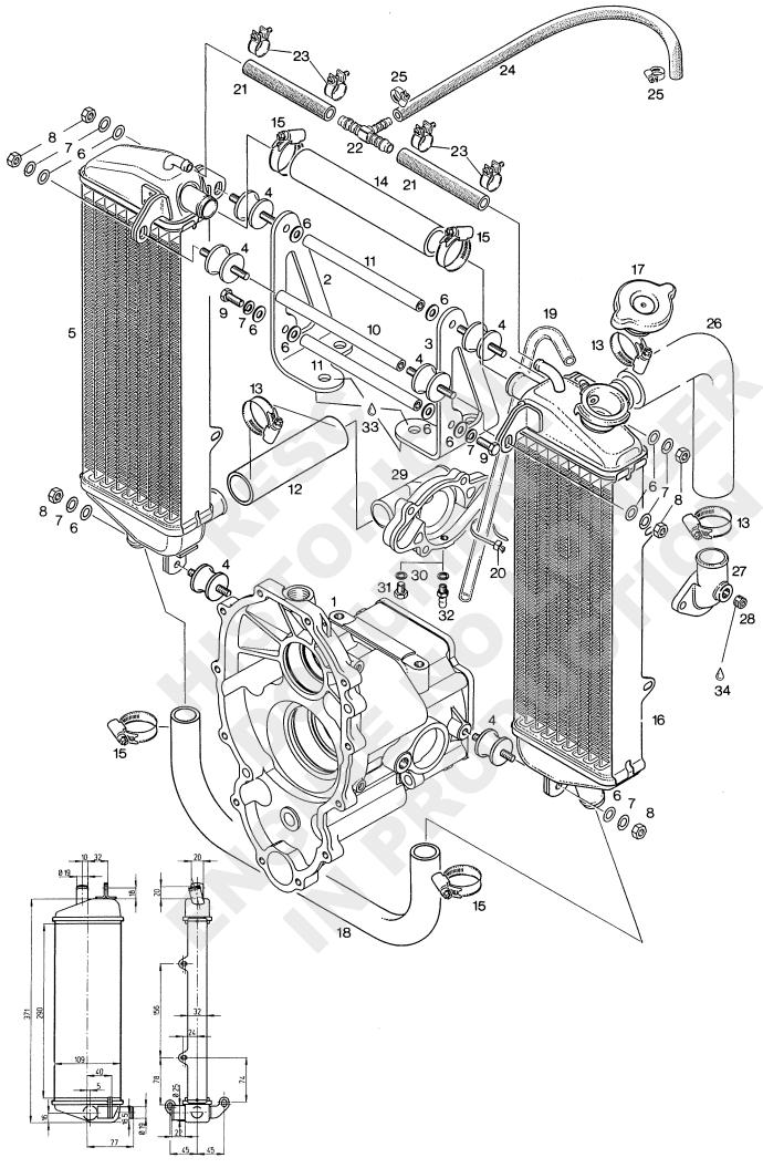
2-TEILIGES KUEHLERSET (KUEHLFLAECHE 2X3,2 DM2) 2-PIECE RADIATOR SET (COOLING SURFACE 2X49,6 IN2)
